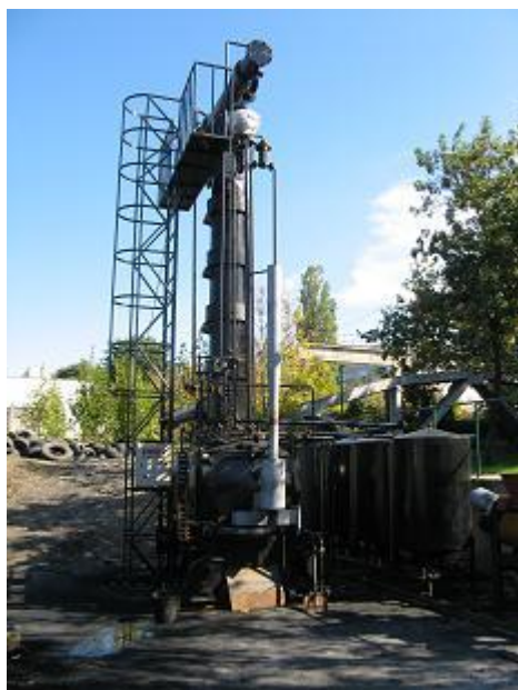
Ректификационная колонна для разделения пиролизного масла
