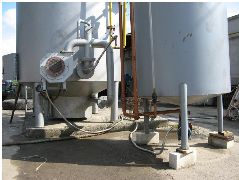
Соединение двух печей для более эффективной работы и возможности накопления большего количества пиролизного газа
