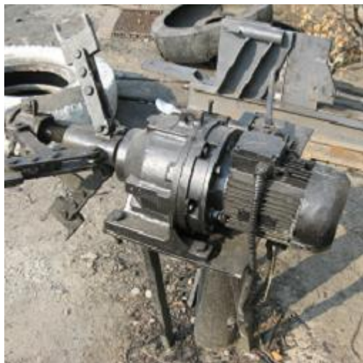
Бортрезный станок для вырезки бортов шин и увеличения плотности загрузки сырья в реторту печи.
