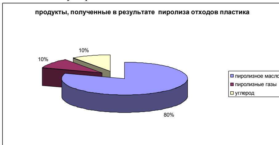
Рис.6.2. Продукты, полученные в результате термического разложения отходов пластика в пиролизных установках FORTAN
